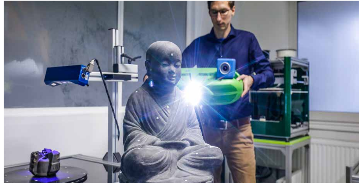
3D-Vermessung von technischen Bauteilen und Skulpturen
