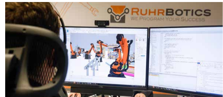
Vor der Inbetriebnahme einer robotergestützten Produktionsanlage wird ein virtuelles Modell erstellt und ausgiebig getestet
